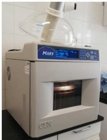
6. kép CEM MARS 5 mikrohullámú roncsolóberendezés (Forrás: Saját fénykép, Gödöllő 2021)
