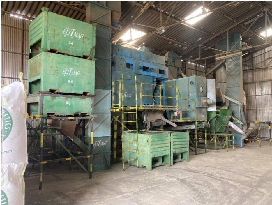
8. ábra Az alap gépsor síkrostája, triőrje és a gravitációs szeparátora a serleges felvonókkal (Forrás: Saját munka)
