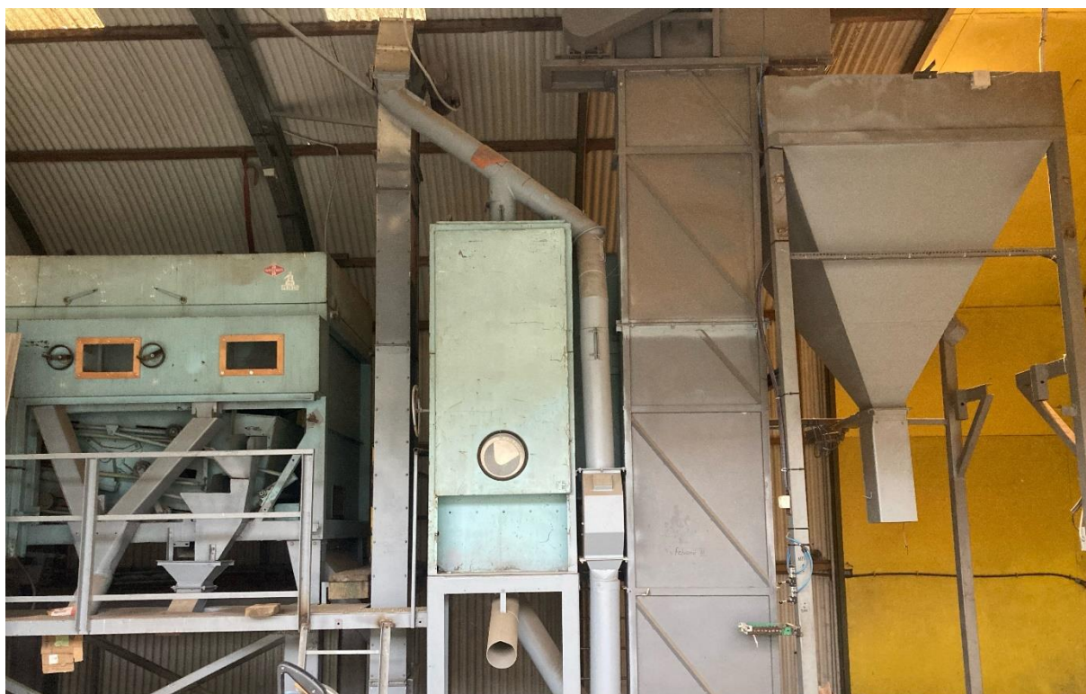
9. ábra Biológia gépsor, rosta, triőr és zsákoló a felvonókkal (Forrás: Saját munka)
