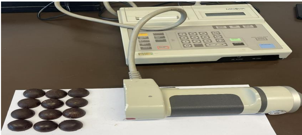
9.ábra: Konica Minolta RS-232C színmérő készülék (Forrás: saját forrás)
