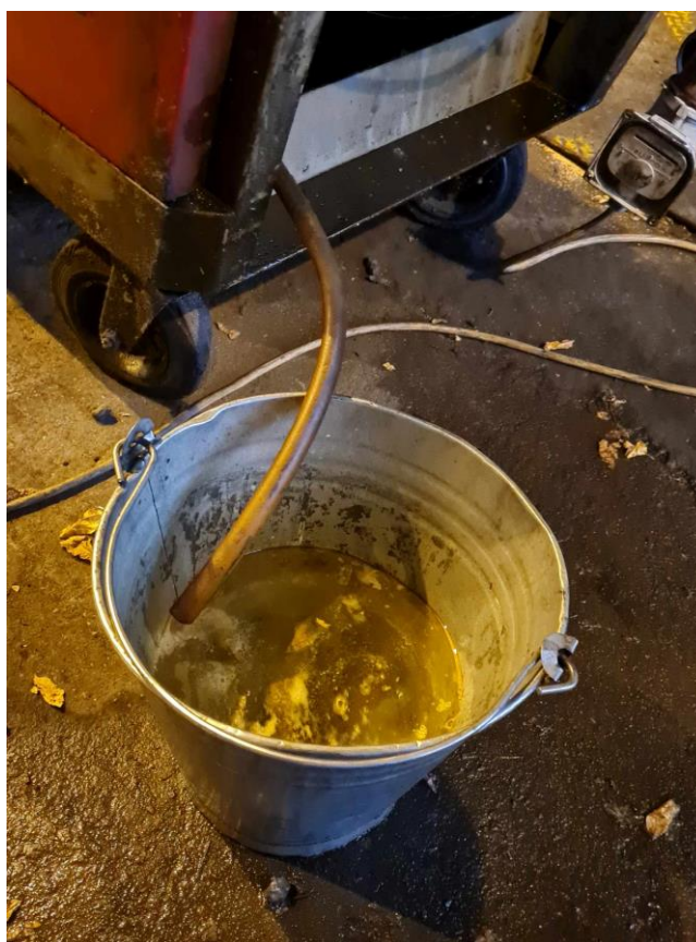
14. Kép: HYDAC Mobil vákuumszeparátor alkalmazás közben (Bal felső kép: a szeparátor oldalnézete; Jobb felső kép: A berendezés és az olajtartály; Alsó kép: a leválasztott víz mennyisége a vödörben látható; Forrás: Saját kép)
