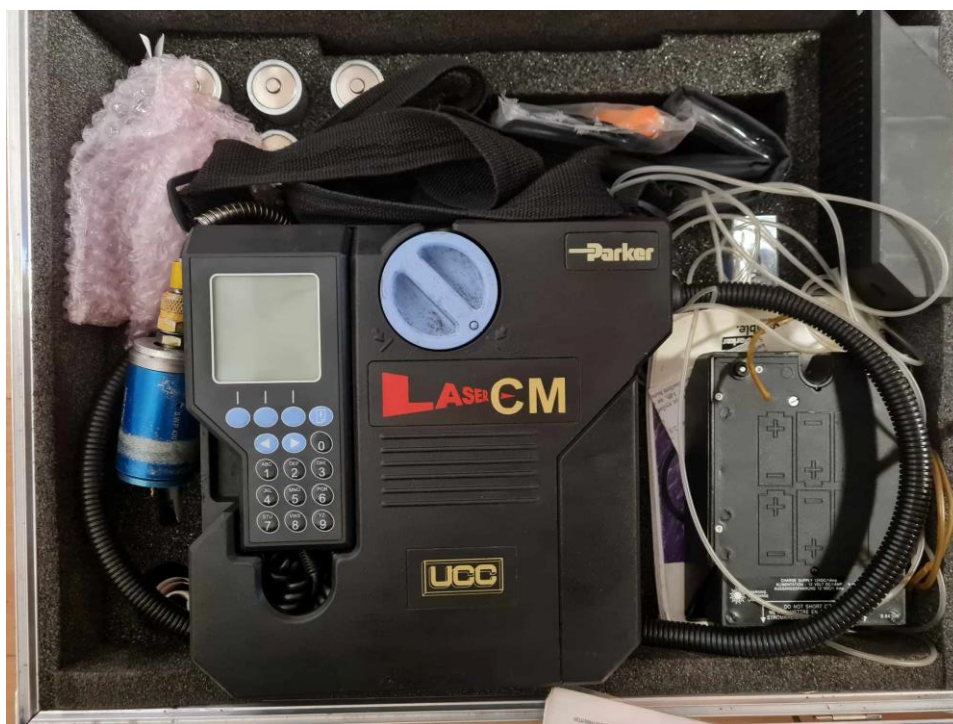
15.Kép: ISO tisztaság mérő, nyomásszabályzóval (LCM20) (Forrás: saját)
