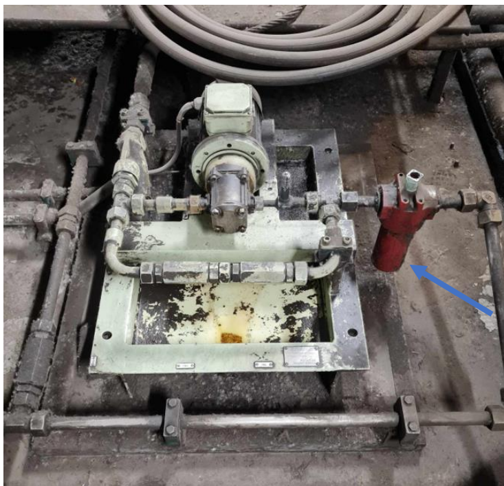
11. Kép Feltöltőági szűrő és a szűrőbetétek (a nyíl mutatja a szűrő elhelyezkedését) (saját)
