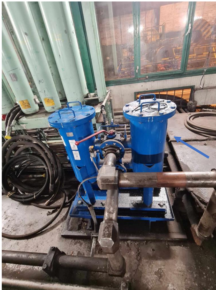
9. Kép Visszatérőági ikerszűrő (a nyíl mutatja a szűrő elhelyezkedését) (Forrás: Saját)
