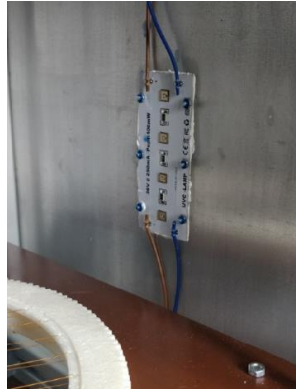
17. ábra A LED-ek helytakarékos hűtése a burkolaton
