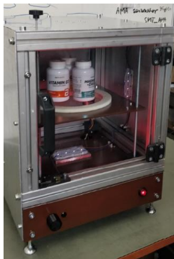
23. ábra Zöld belső világítás esetén nincs sugárzás 24. ábra Pirosbelső világítás esetén sugárzás van, de ajtónyitásra kikapcsol
