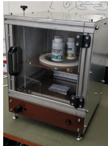
21. ábra Tárgyasztal mechanikusan emelhető, süllyeszthető a tetején lévő forgatógombbal
