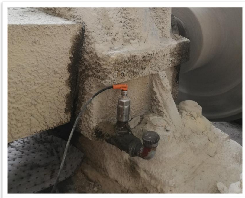
12. ábra. Olajsint szenzor ellenőrző kupakkal (saját fotó)
