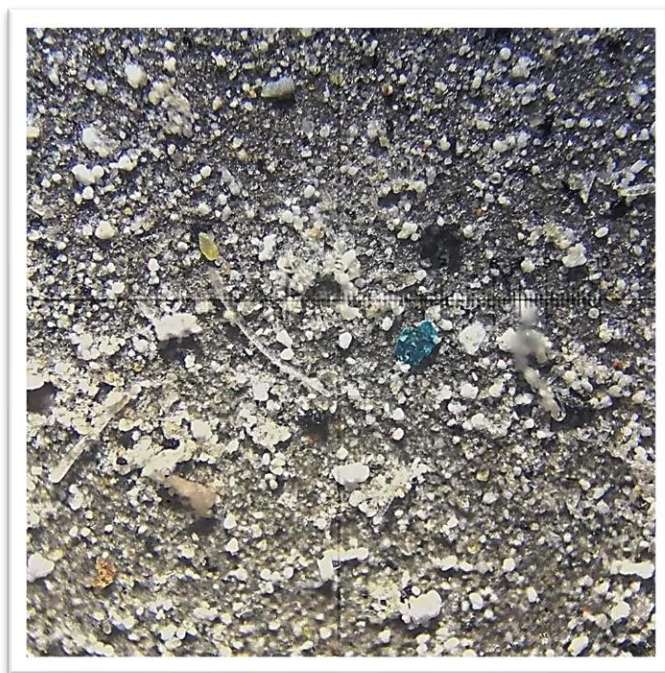
24. ábra. Csapágyolaj szennyezőanyagtartalom mikroszkópos felvétele (saját fotó)
