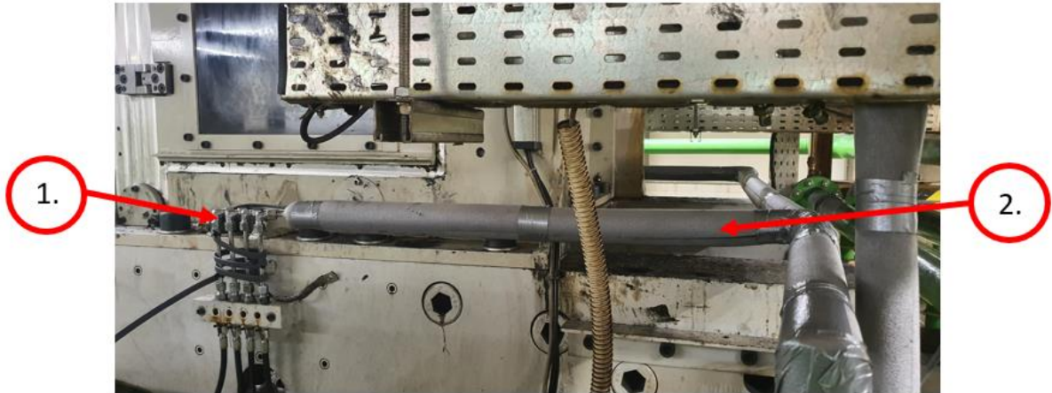
7.2. ábra Szigetelt, fűtéssel ellátott új kenővezeték elhelyezkedése a kenési pontok közelében (saját)
