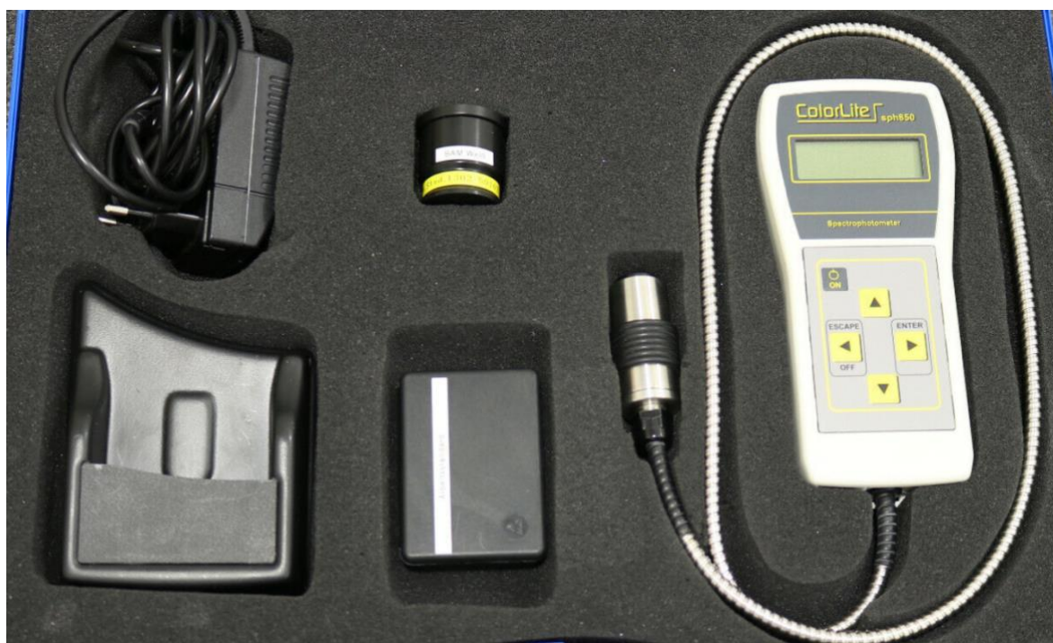
21. ábra: A színméréshez használt ColorLite sph 850 kézi spektrofotométer (Forrás: saját fotó)
