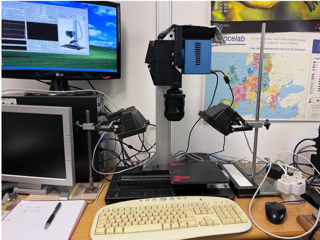
19. ábra: A hiperspektrális méréshez használt mérőműszer: HeadWall rendszer (Forrás: saját fotó)
