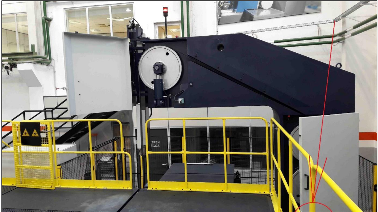
4.2. ábra – DANOBAT CNC fűrészlapját feszítő tárcsasor (hajtómű elhelyezkedésének jelölésével)
