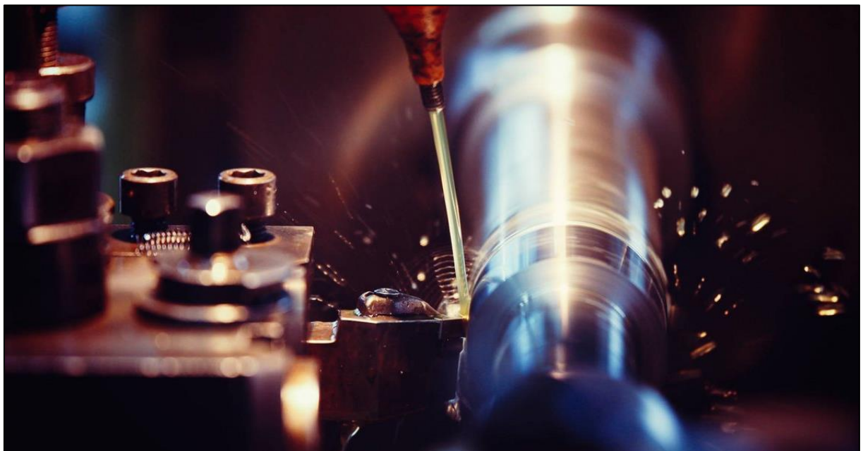
3.11. ábra – Munkadarab hűtése hagyományos esztergán
