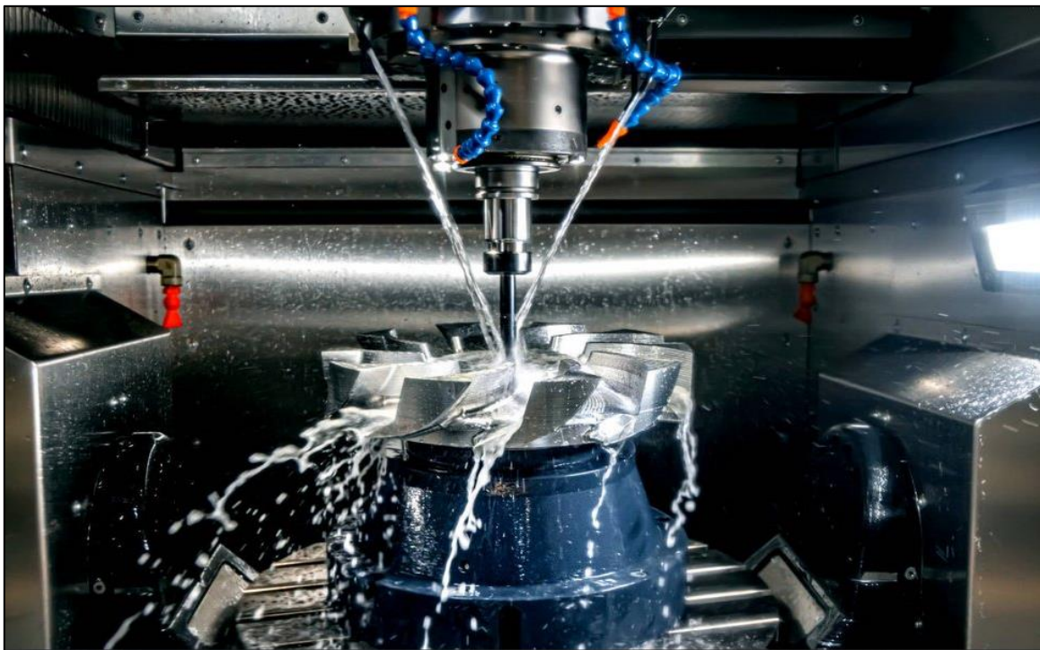
3.12. ábra – Marószerszám hűtése, megmunkálás közben
