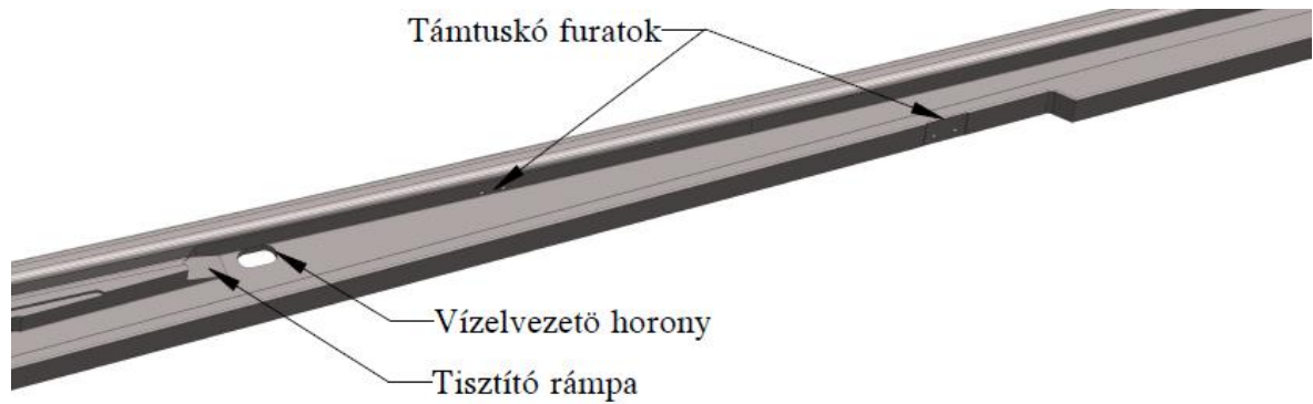
5.46. ábra: Belső félváltó felső tömbjének támtuskó furatai, vízvezető hornya és tisztító rámpája
