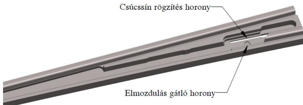
5.8. ábra: Külső félváltó csúcssín rögzítésének és elmozdulás gátlásának kialakítása
