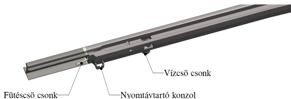
5.19. ábra: Külső monoblokkra hegesztett fűtéseső csonk, nyomtávtartó konzol és vízeső csonk
