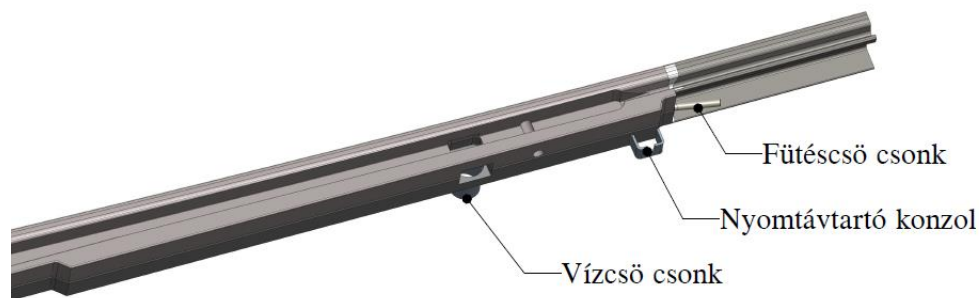
5.53. ábra: Belső monoblokkra hegesztett vízcső csomak, nyomtávtartó konzol és fűtésű csomak
