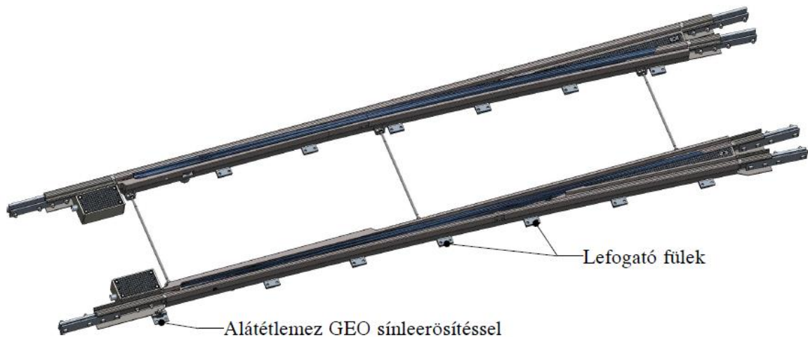
5.28. ábra: Keresztaljakra rögzíthető Ph 100 MB típusú váltórész
