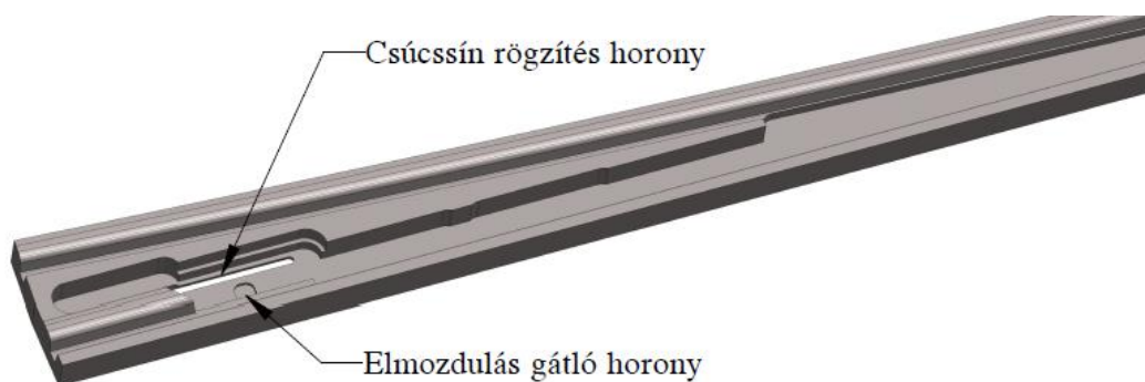
5.42. ábra: Belső félváltó csúcssín rögzítésének és elmozdulás gátlásának kialakítása
