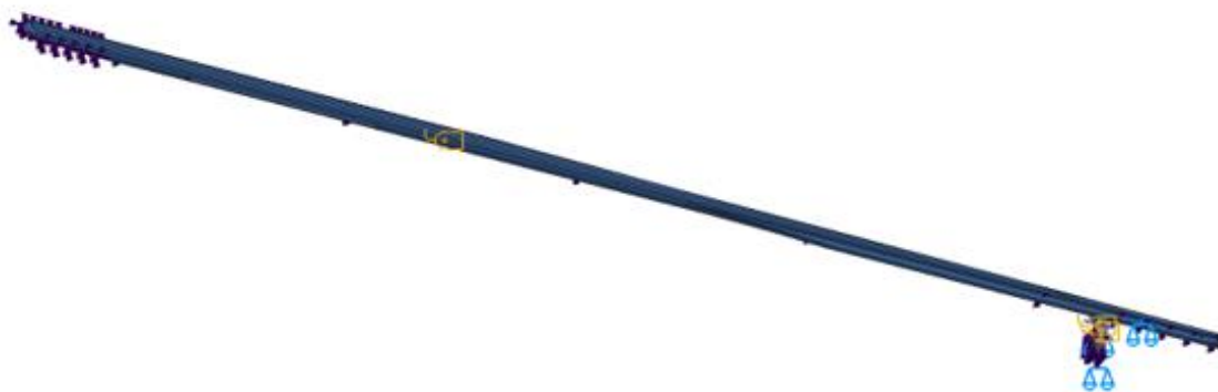
5.34. ábra: Ph 100 MB típusú egyenes csúcssínre elhelyezett kényszerek
