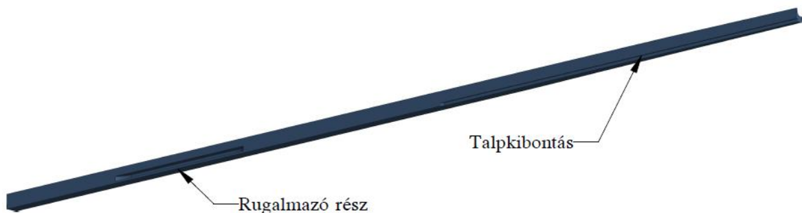
5.22. ábra: Íves csúcssín talpkibontása és rugalmazó része
