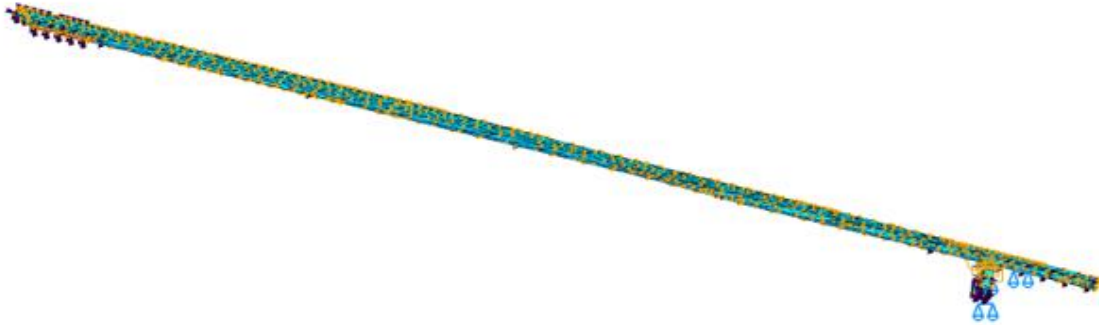
5.35. ábra: Ph 100 MB csúcssín hálózott végeselem modellje
