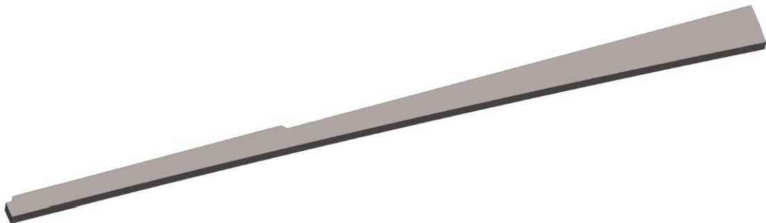
5.39. ábra: Belső félváltó felső tömbjének előgyártmánya
