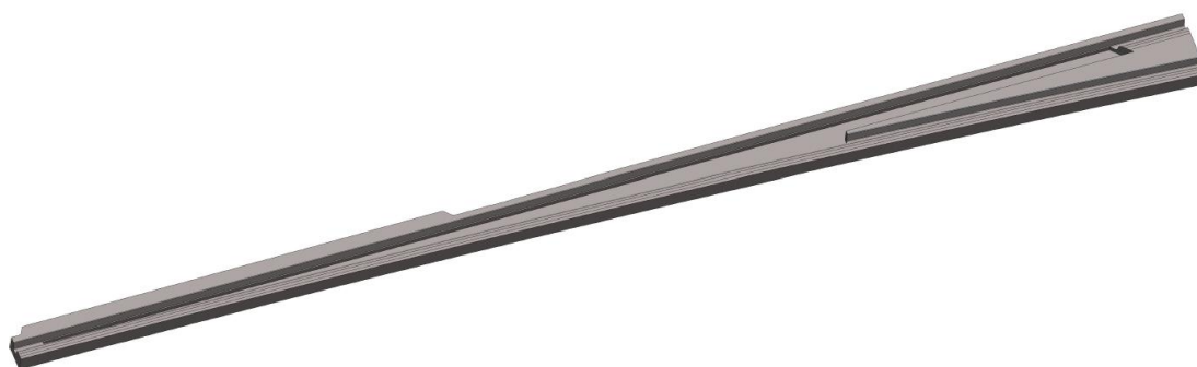
5.41. ábra: Belső félváltó felső tömb csúcssín férőhelyek
