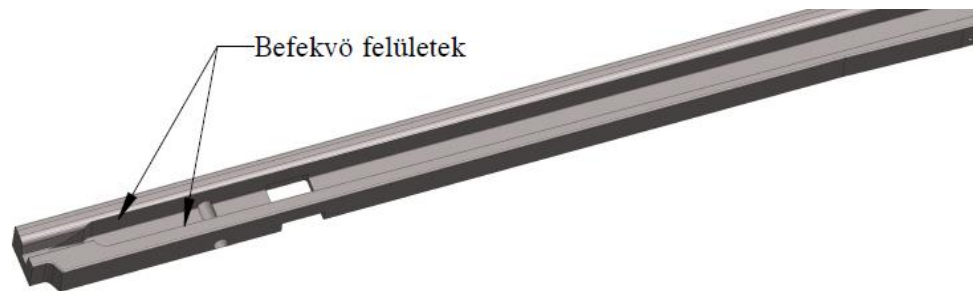
5.11. ábra: Külső félváltó felső tömbjének befekvő felületei
