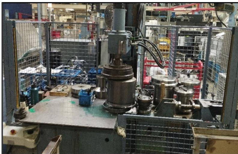
25. ábra – A gép munkatérének elburkolása [saját készítés]
