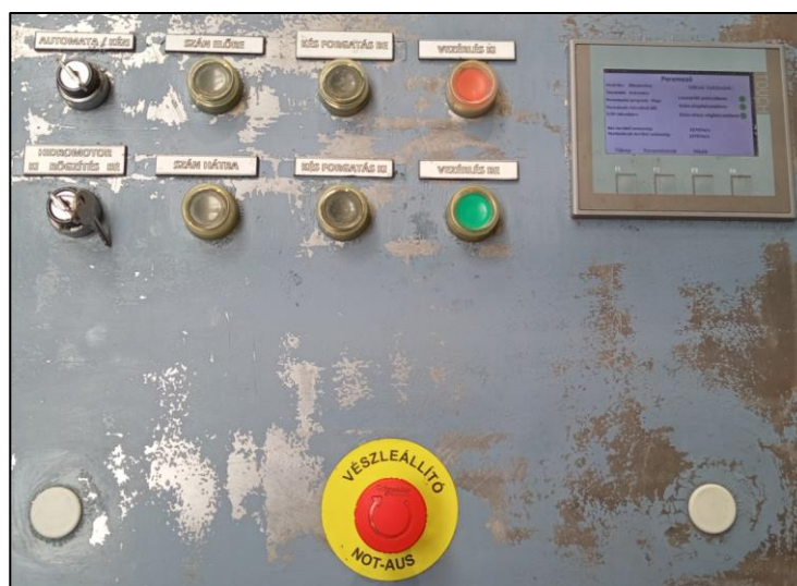
28. ábra – Funkcionális azonosítással ellátott kezelőelemek a berendezés kezelőpultján [saját készítés]
