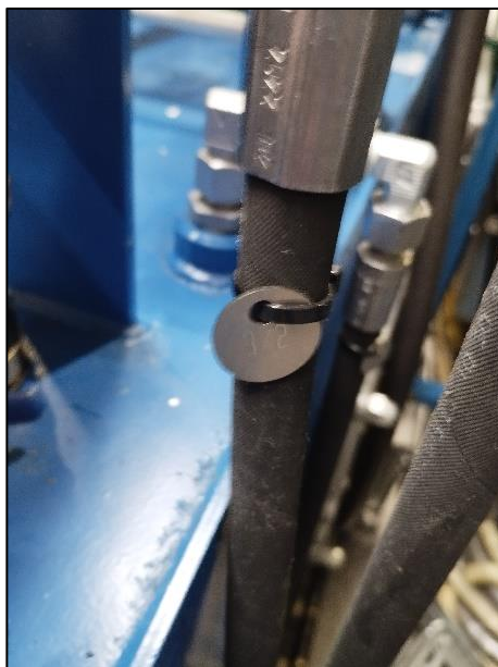
30. ábra – Egyedi azonosítóval ellátott hidraulikus tömlő [saját készítés]
