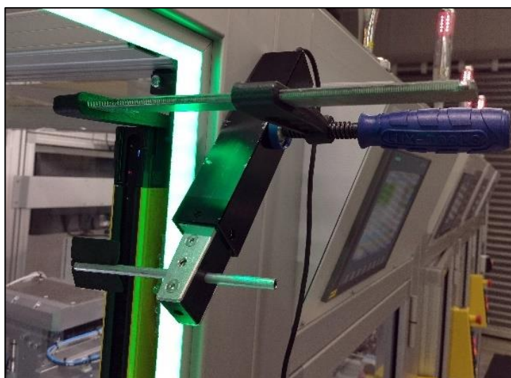
10. ábra - Fényfüggöny működtetése „auto-hand”-del [saját készítés]
