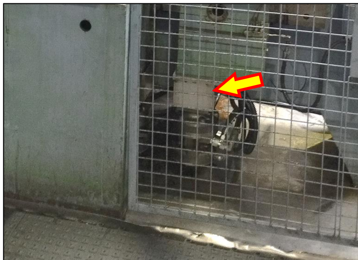
26. ábra – Hidraulikus motorok elburkolt tengelykapcsolói [saját készítés]
