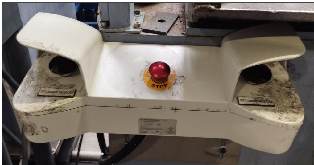
29. ábra – Új kétkezes kapcsoló funkcionális azonosítással ellátva [saját készítés]
