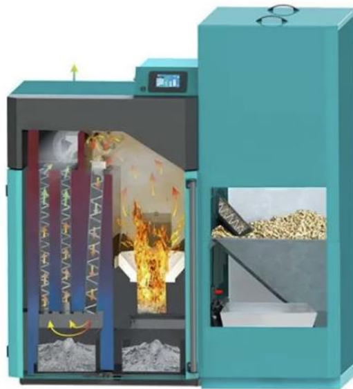
17. ábra: Pelletkazán sematikus ábrája [Sasi Gábor (2023/3. lapszám) Megújuló energia fűtési célú hasznosítása a napelemen túl. VGF szaklap]
