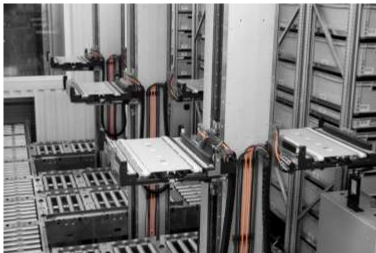
4.3.4. ábra Pálya elemek és rakodó robot [9]
