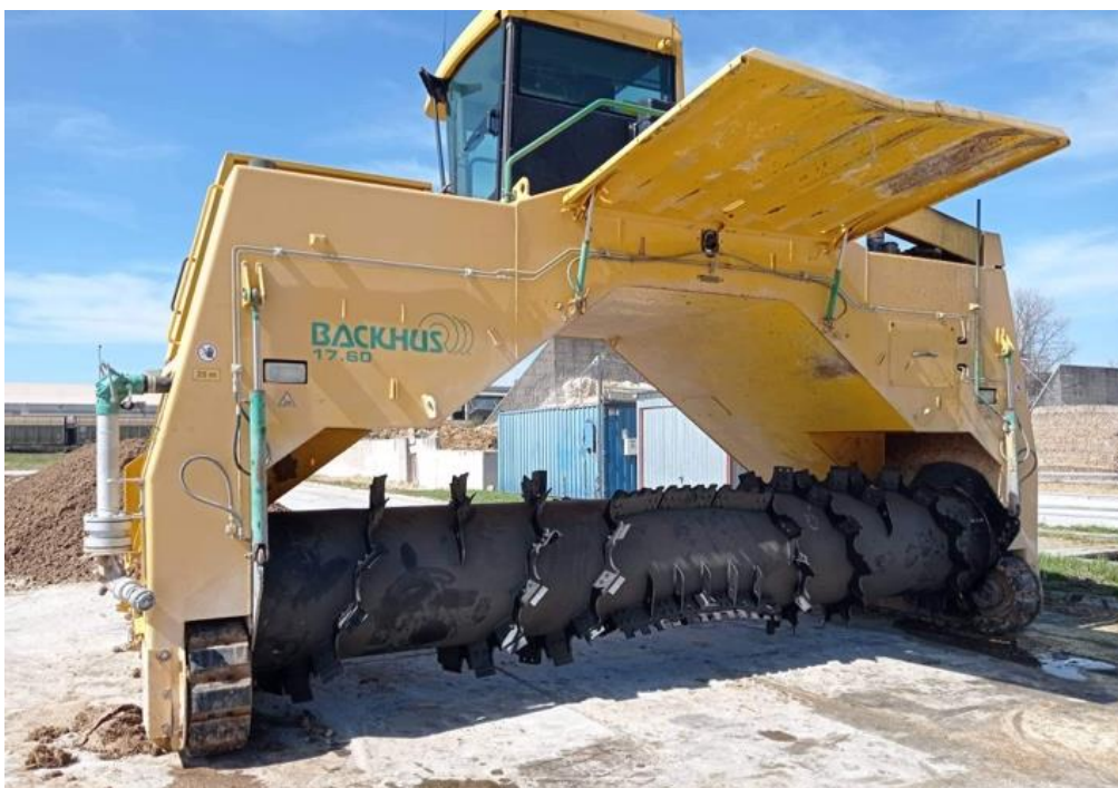
11. ábra - Backhus 17.60 típusú komposztforgató célgép (forrás: saját)
