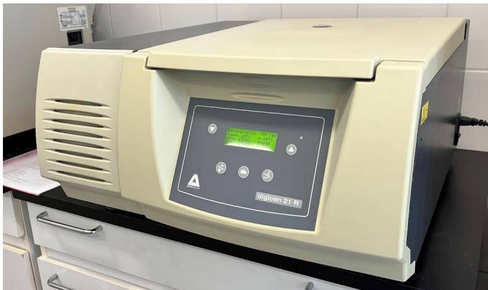
20. ábra - digicen 21 R típusú laborcentrifuga (forrás: saját)
