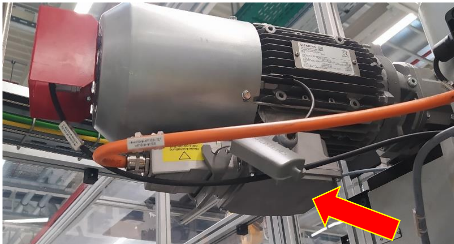
15. ábra Veszélyre figyelmeztető piktogram hiánya (forrás: saját kép)
