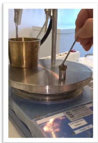
7. kép: Viasz felvitele kalottára (forrás: saját fotó)
