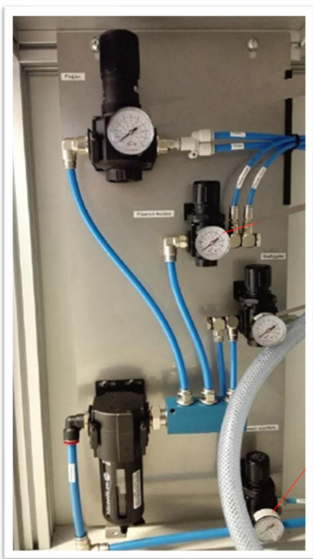
15. kép: Marógép nyomásszabályozói (forrás : saját fotó)
