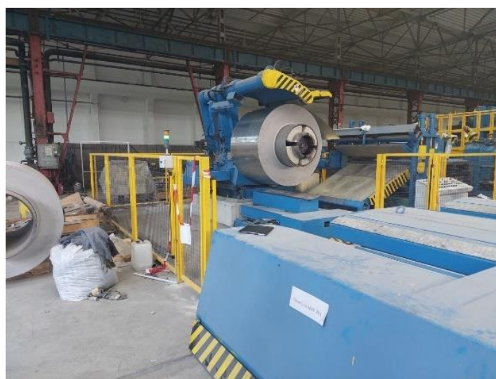
2. kép Friss tekercs a lecsévélőn, előtérben a tekercskocsival
