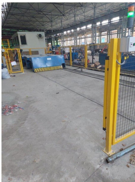
21. kép TVF1 fényfüggönypár (Saját fénykép)
