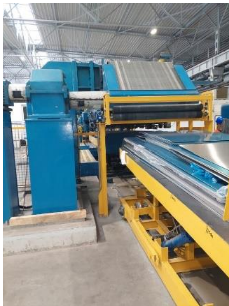
12. kép Selejt lemezek a kidobó egységen
