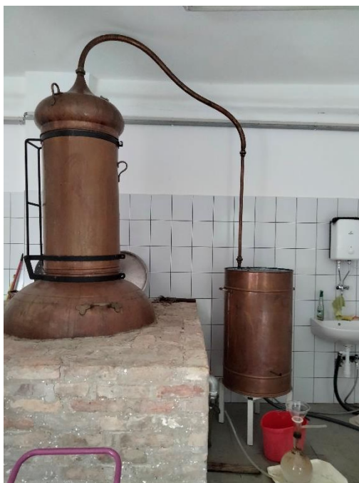
18. ábra: Gyógynövények völgye víz-gőzlepárló berendezés
