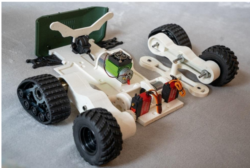
8.1. ábra - Terepjáró speciális járószerkezetének gyártott alkatrészei
