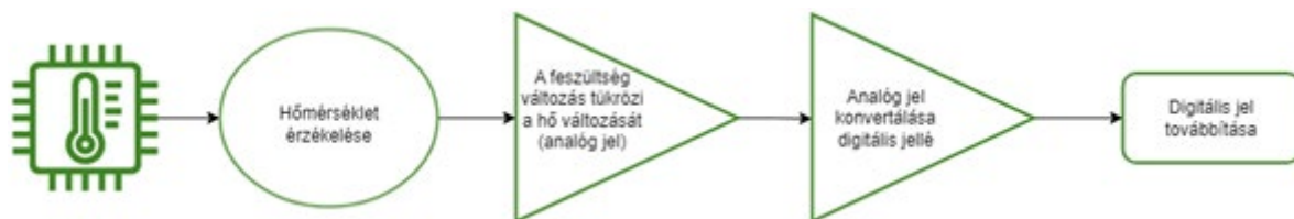
1. ábra A fizikai jellemző digitális jellé konvertálása
