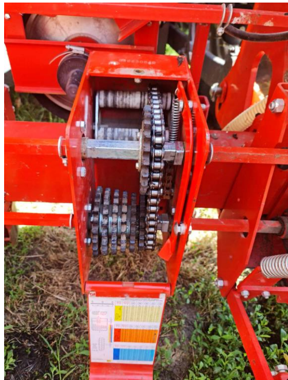
8.ábra: áttétel módosítás Forrás:ábrajegyzék
