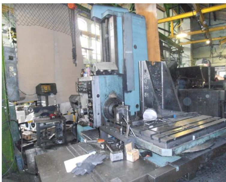
5.15. ábra WHN90-B vízszintes marógép
