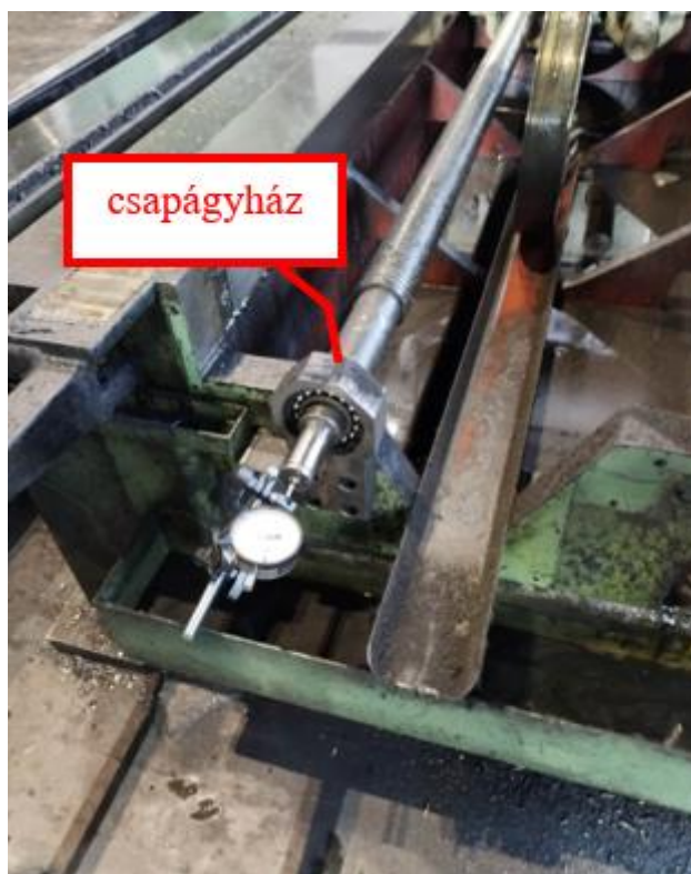
4.2. ábra X tengelyű golyósorsó csapágyházzal
