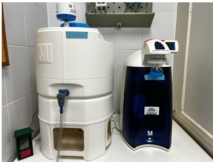
1. kép: Merck Direct Q-3 UV Víz tisztító berendezés (Forrás: Saját fotó)
