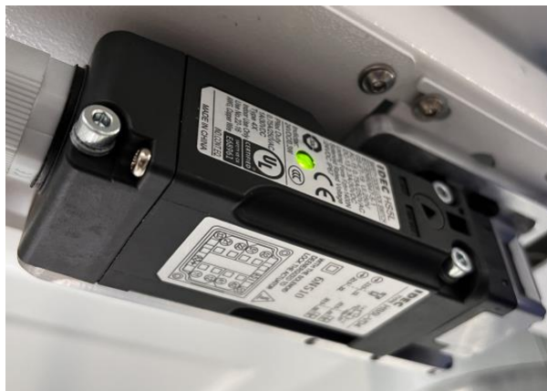
4. kép IDEC, HS5L-VD4 burkolatzáró szerkezetes reteszelő berendezés [forrás: saját]
