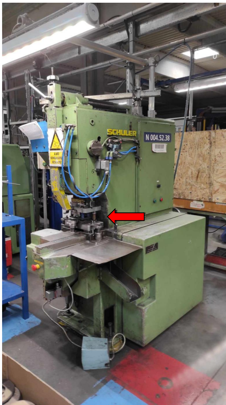
8. ábra Kónuszos excenter présgépen az oldalirányból nyitott munkatér veszélye (forrás: saját kép)
