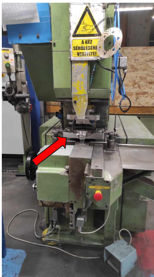
7. ábra Kónuszos excenter présgépen a frontálisan nyitott munkatér veszélye (forrás: saját kép)
