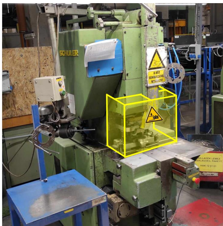
18. ábra Kónuszos excenter prégépen a frontálisan nyitott munkatér veszélyének elhárítása (forrás: saját szerkesztés)
