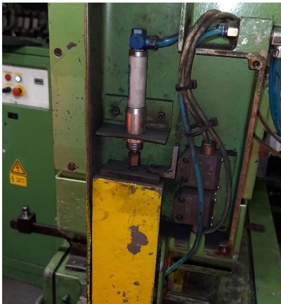
11. ábra Kónuszos excenter prégépen pneumatikus rendszerben levő szerkezeti elemek azonosításának hiánya (forrás: saját kép)
