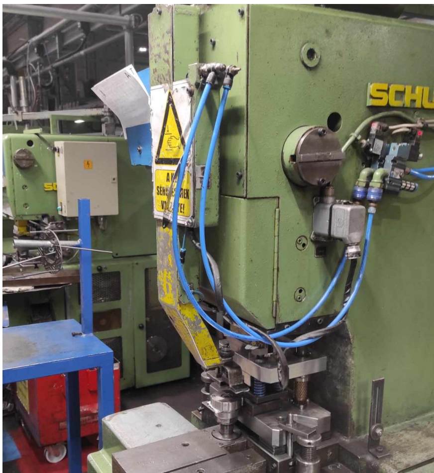
10. ábra Kónuszos excenter présgépen pneumatikus rendszerben levő szerkezeti elemek azonosításának hiánya (forrás: saját kép)
