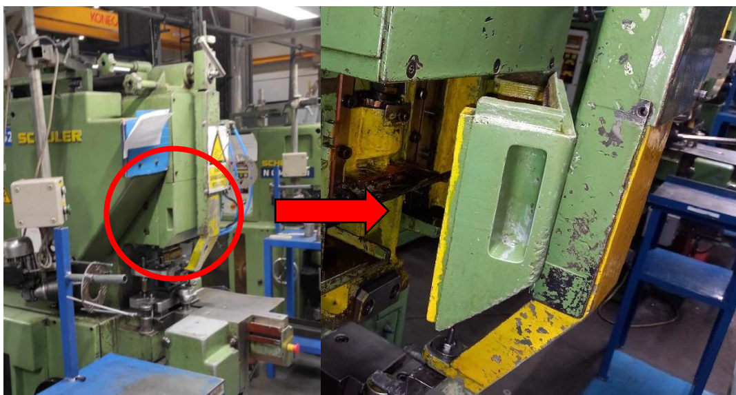
9. ábra Kónuszos excenter prégépen a frontoldali védőburkolat nyithatósága (forrás: saját kép)
