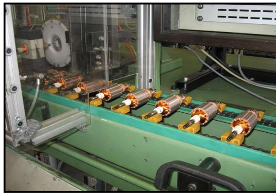
1. KÉP SZÁLLÍTÓSZALAG FORGÓRÉSZEKKEL (FORRÁS: SAJÁT)
