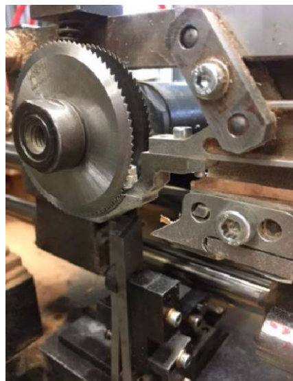
4. KÉP NÚTLEZÁRÓ GÉP DUPLA VÁGÓÉLE (FORRÁS: SAJÁT)
