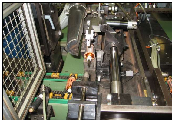
2. KÉP PAPIRHAJTOGATÁSA A NÚTOKBA (FORRÁS: SAJÁT)
