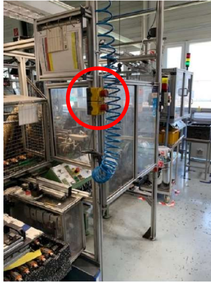
5. KÉP NÚTLEZÁRÓ GÉPEN ELHELYEZETT VÉSZSTOPGOMB (FORRÁS: SAJÁT)
