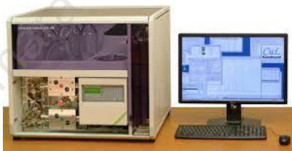
9. ábra AAA 400 Automatikus Aminosav Analizátor (Forrás: Internet 2.)
