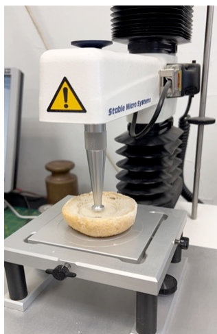
7. ábra Az SMS TA-XTplusz precíziós állománymérő berendezés mérés közben (Forrás: saját felvétel)
