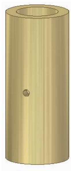
21. ábra Munkadarab 3D modellje a készítendő furattal [saját ábra]
