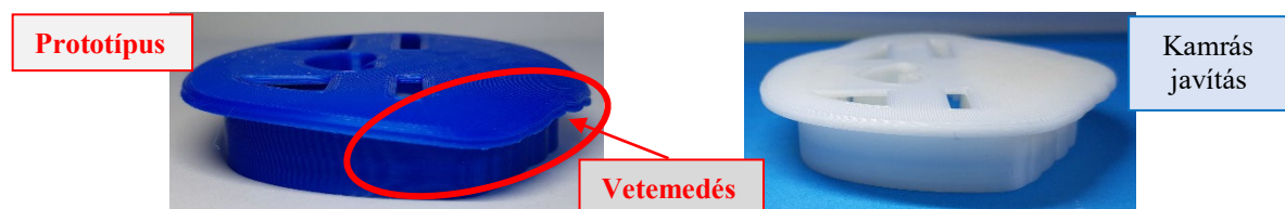
4.18. ábra: S_Minta_3_Coffee prototípus modelljén látható vetemedés (balra) [41]
