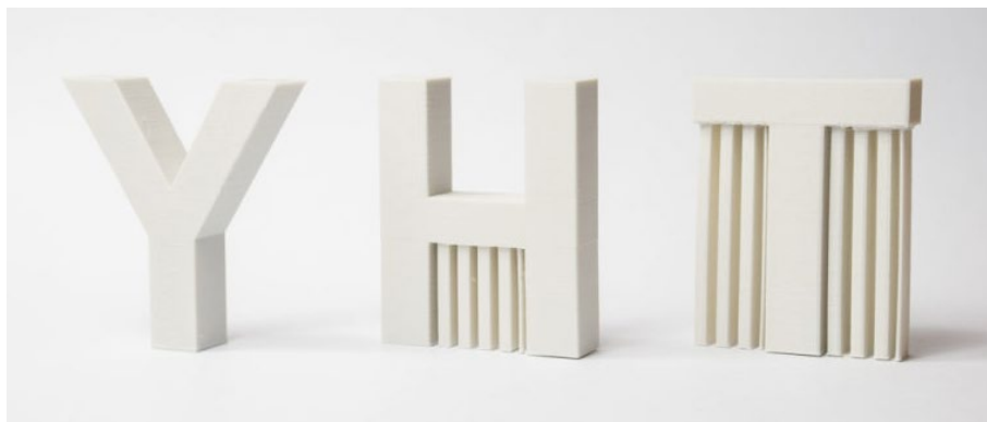
2.9. ábra: Support nélküli "Y", és supporttal nyomtatott „H” és "T" betűk [33]
