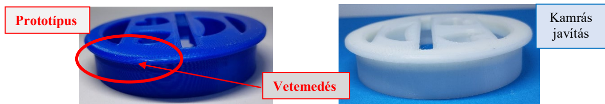
4.16. ábra: Az S_Minta_7_Happy_smiley prototípusán vetemedés látható (oldalnézet) [41]
