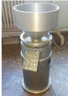
11. ábra: Koptatógép a kalászek feldolgozásához (Kiss László, 2023)
