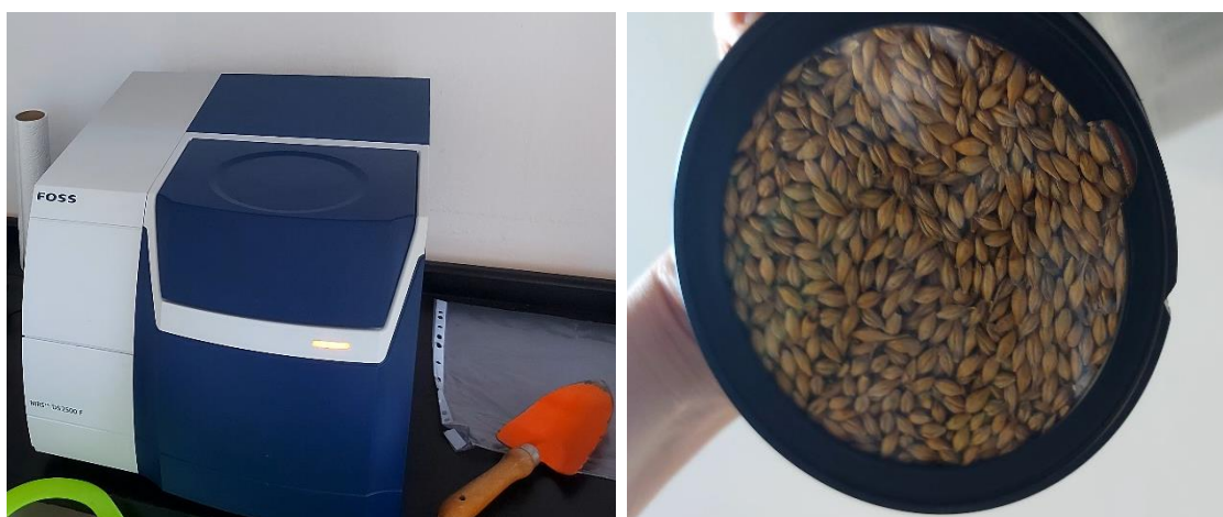
13. ábra: Foss Nirs 2500F terményvizsgáló készülék a mérőedénnyel (Kiss László, 2023)
