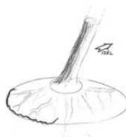
7. ábra: Íves talajrepedés a törzstől távolabb (forrás: Lukács, 2018)
