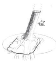
12. ábra: „U” alakú talajrepedés (forrás: Lukács, 2018)
