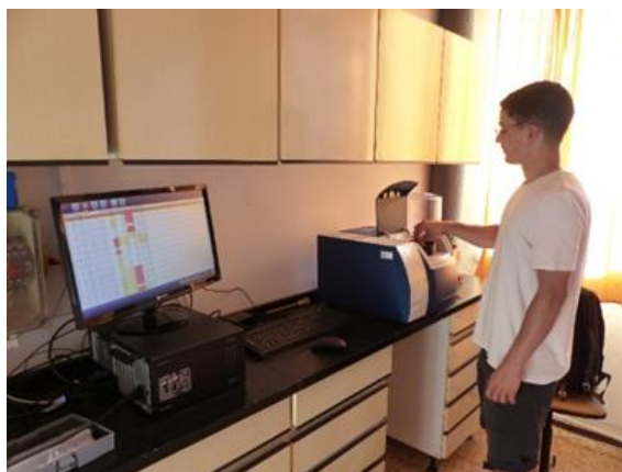
7. ábra Levélminták NIR műszeres mérése (LEPOSSA, 2023)
