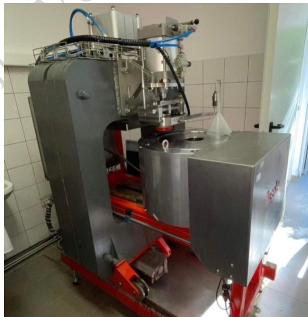
3. ábra: Resato FPU-100-2000 típusú nagy hidrosztatikus nyomású élelmiszer-tartósító berendezés kezelőtere (Forrás: saját felvétel)
