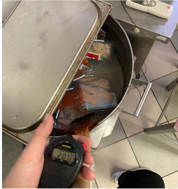
5. ábra: Smoothie-minták hőkezelése 60 °C-os vízfürdőben (Forrás: saját felvétel)
