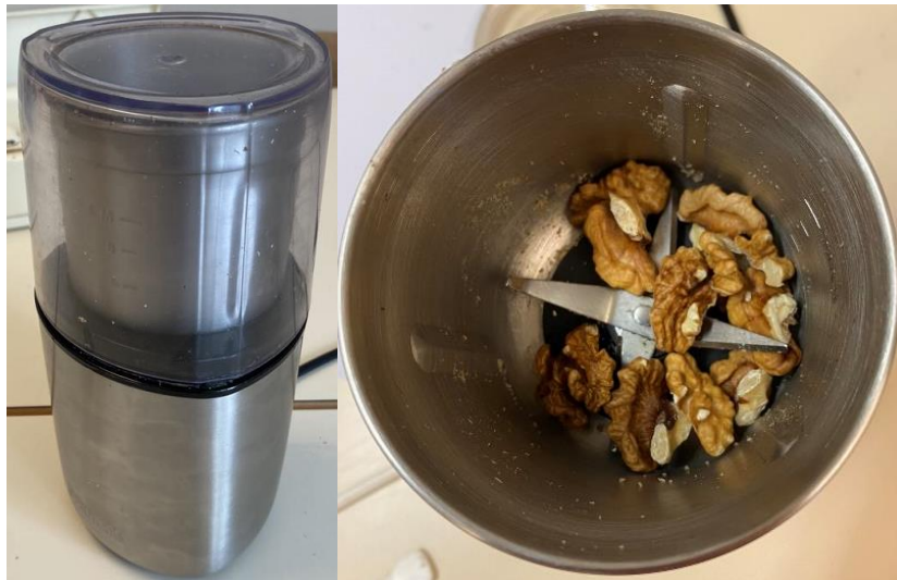
11. ábra: Bal oldalt a Princess 221040 Multi Chopper and Grinder aprítóberendezés, jobb oldalt pedig a berendezés, benne ~20 g aprítatlan minta
