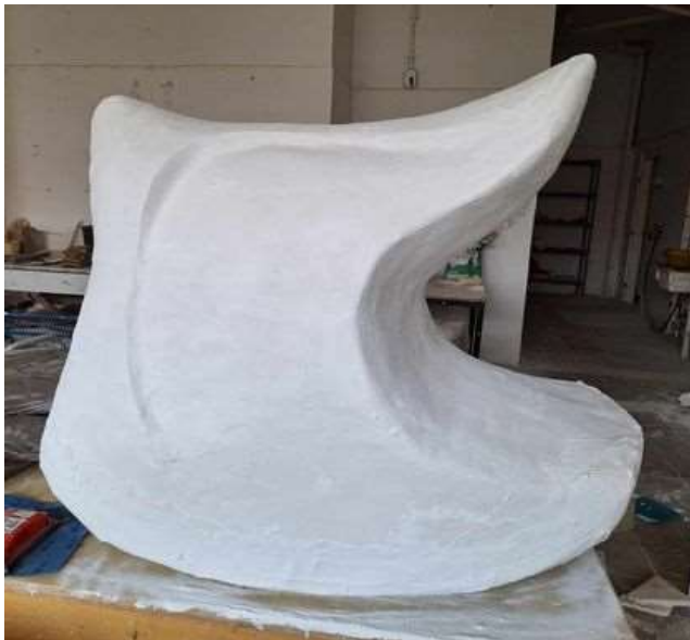
22. Ábra: A gipszes gézzel lefedett hungarocellréteg
