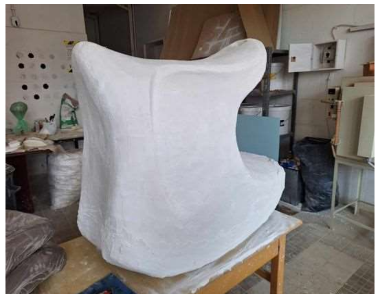
21. ábra a második réteg gipsz után, csiszolási fázisban
