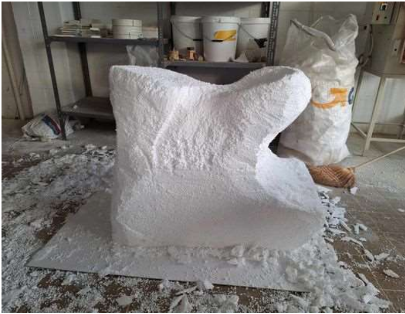
19. ábra: Itt már fokozottan figyelni kell a méretarányokra, lassan kialakul a forma. Az ülőrész mélysége elérte a kívánt méretet.
