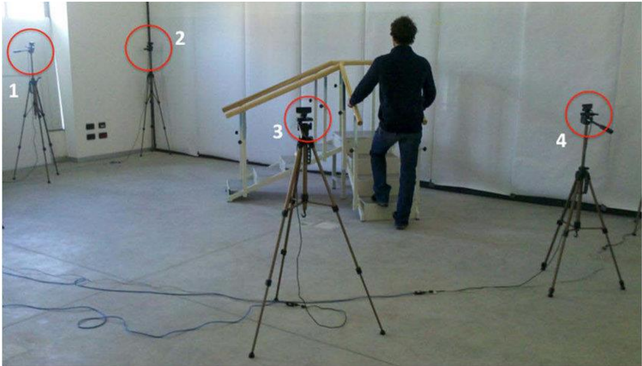
7. ábra: Több kamerás mozgásrögzítés, optikai markerek nélkül (Giorgio Colombo, researchgate.com)
