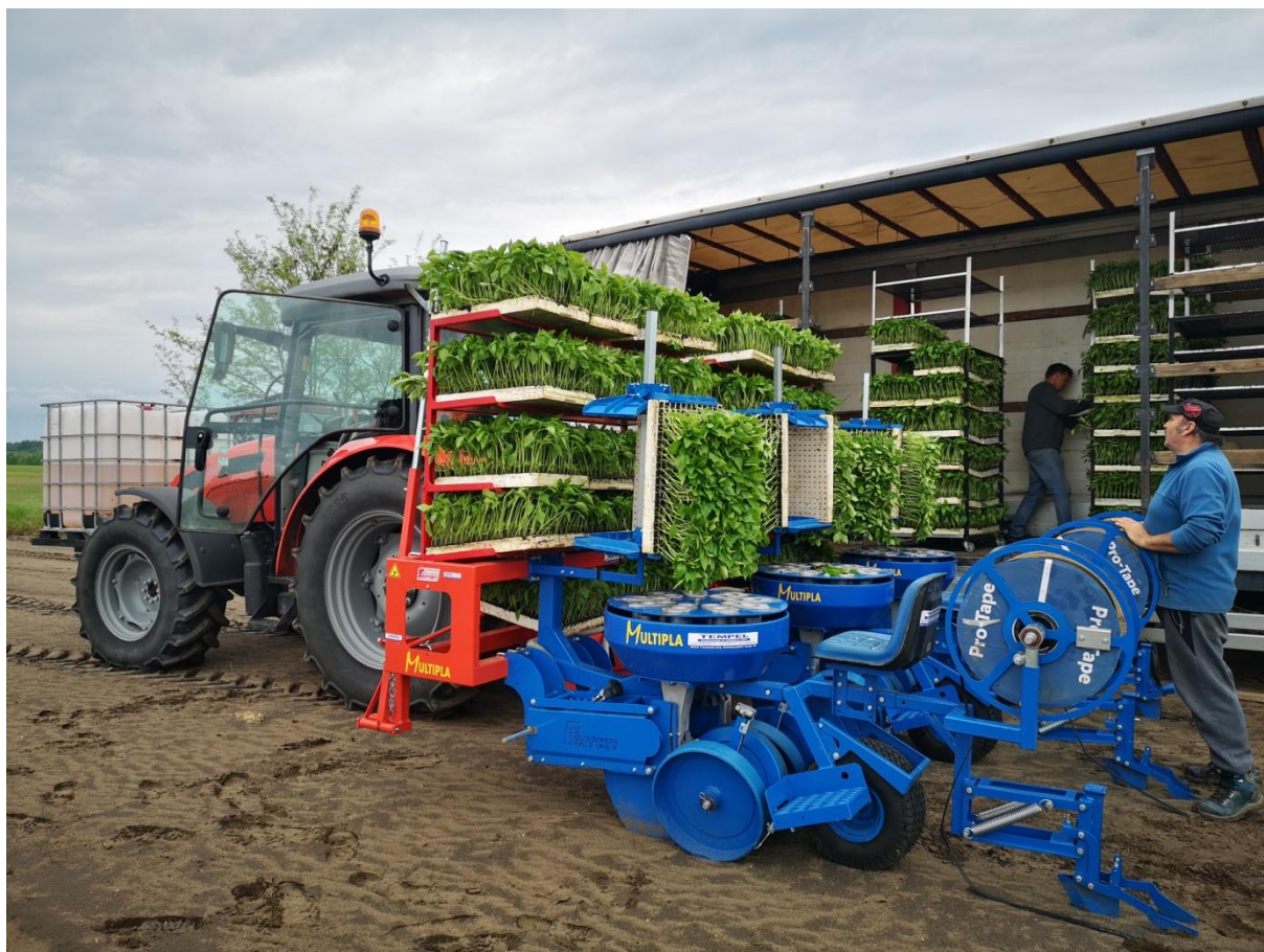
5. ábra Ferrari Multipla palántázó gép és Same Explorer 100 MD GS erőgép
