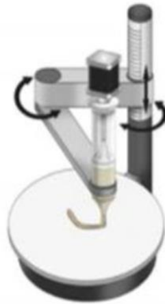
3. ábra: SCARA típusú 3D nyomtató kinematikája [11]
