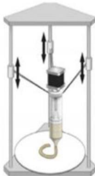
4. ábra: Delta típusú 3D nyomtató kinematikája [11]
