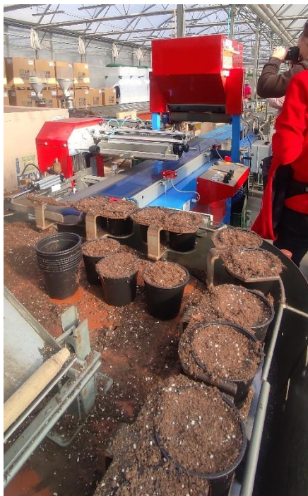
18. ábra.: Automatizált cserepelés
