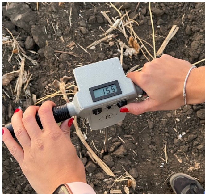
7. ábra A talajnedvesség mérése
