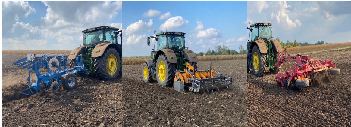
5. ábra A kísérletben alkalmazott néhány eszköz, Balról jobbra: Rabewerk Albatros 4 fejes eke, Spider típusú 5 késes lazító, Väderstad Carrier 4,5 méteres síktárcsa
