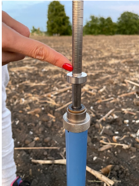
6. ábra A talajellenállás mérése penetrométerrel
