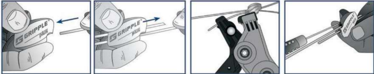
3. ábra: huzalfeszítő megfelelő használata (Griple kiadvány)
