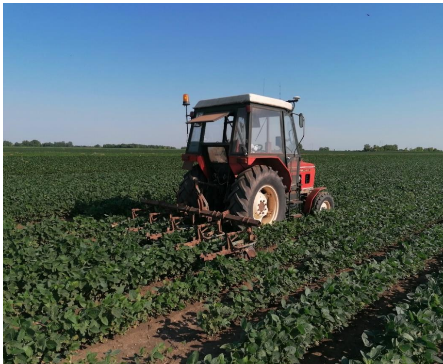
7. ábra: Szója gyommentesítése sorközművelő kultivátorral (Saját forrás)
