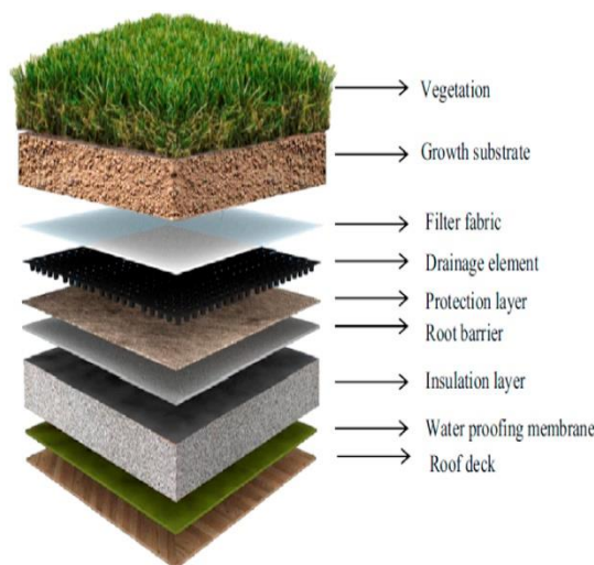
7. ábra: Zöldtetők szerkezeti elemeinek vázlata (Forrás: Besír -Cuce, 2018)
