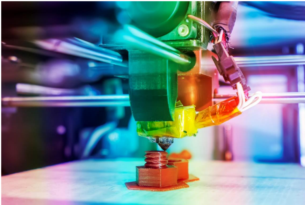
1. ábra - Műanyag nyomtatás FDM nyomtatóval [ https://www.tonerpartners.hu ]
