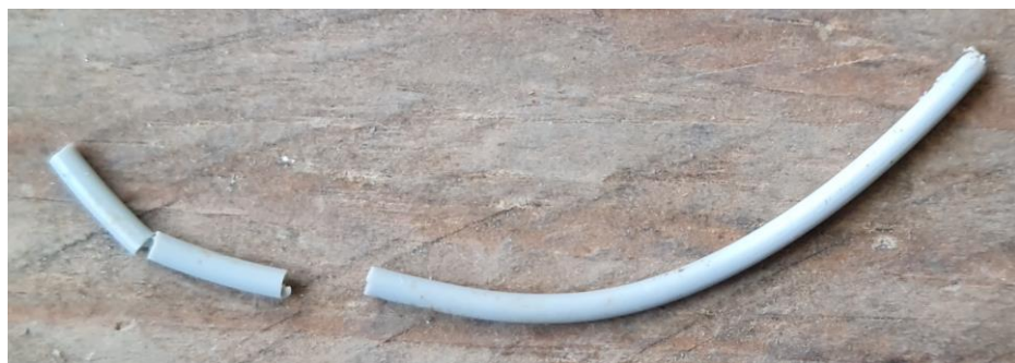
22. ábra - Az UV fény és a magas hőmérséklet hatására eltört ABS szál [Saját ábra]
