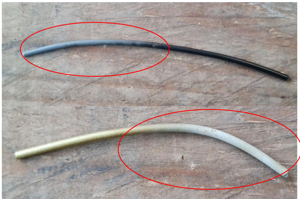
21. ábra - Színek elváltozása a filamenteken [Saját fotó]
