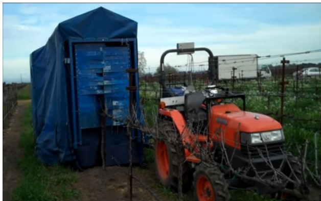
1. ábra Az Intelligent Autonomous Grapevine Pruner az ültetvényben (Forrás: https://www.visionrobotics.com/vr-grapevine-pruner - beágyazott videó)
