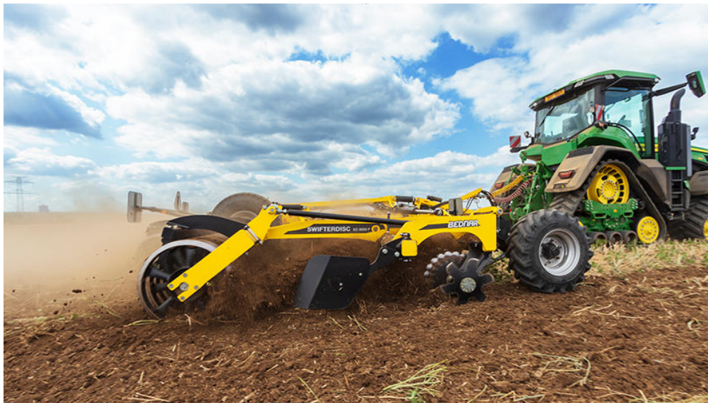
5. kép Bednár tárcsás kultivátor tarlóhántást végez (internet)
