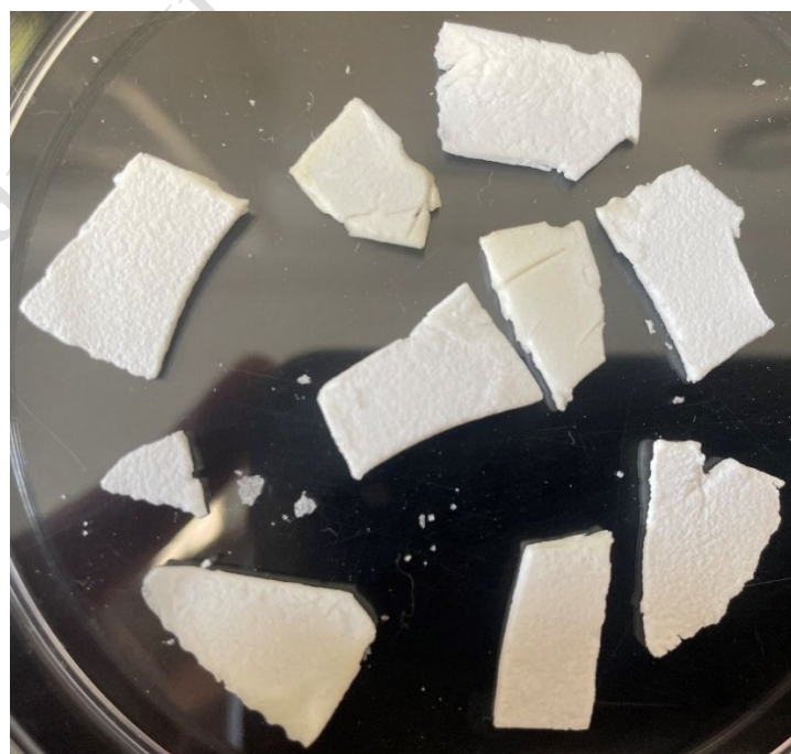
25. Ábra PLA darabok bontás után
