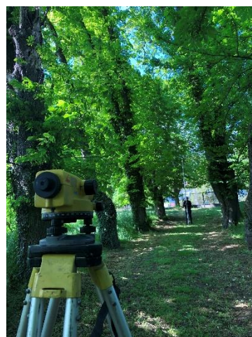
31. ábra Szintezés mérőműszerrel, forrás: Saját kép
