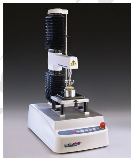
8. ábra SMS TA-XTplus állományvizsgáló készülék (forrás: URL 4 )
