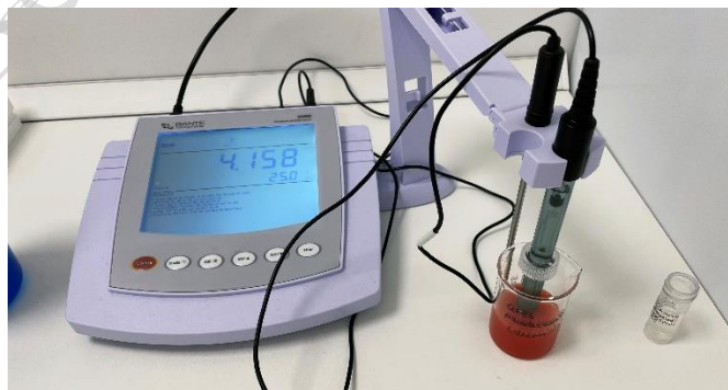
13. ábra: digitális pH mérő készülék (saját fotó)
