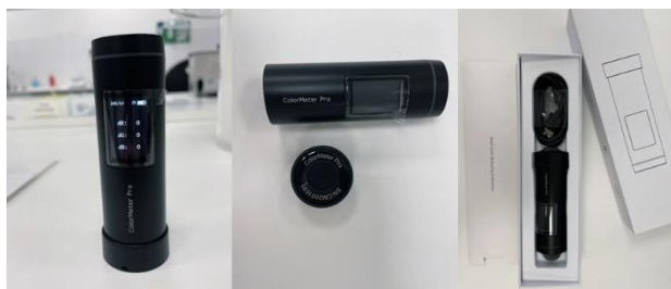
14. ábra: Colormeter pro színmérő műszer (saját fotó)
